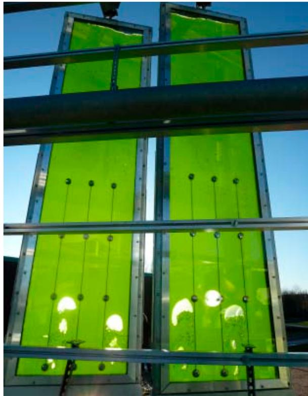
Trägersystem mit installierten PBR-Paneelen aus Kunststoff auf der Pilotanlage von SSC in HH Reitbrook
