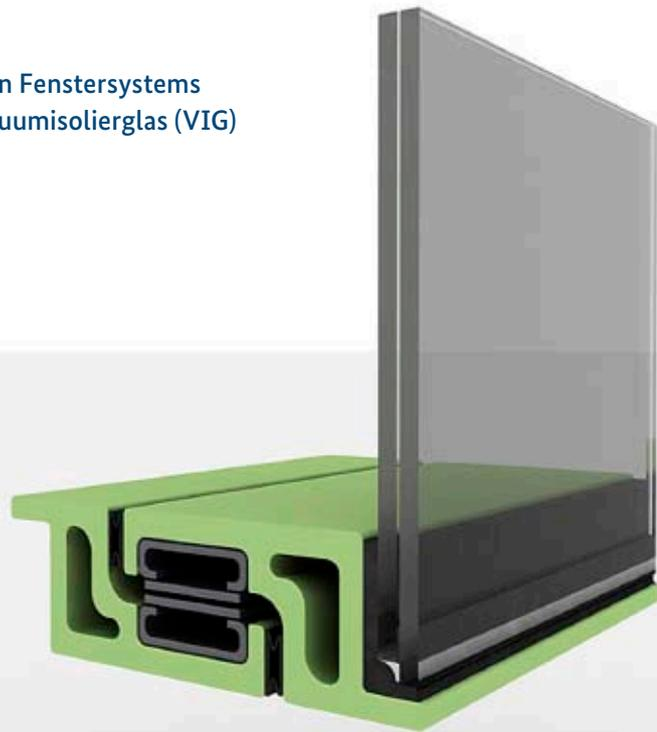
Moderne Wärmeschutzfenster mit Dreifachverglasungen (Passivhausfenster) bieten niedrige U-Werte, erkaufen dies aber mit hohem Eigengewicht. Dies kann etwa den Einbau in Altbauten erschweren. Auch sind zum Tragen der drei Scheiben mit Kunststoffrahmen breite Profile erforderlich, was die Gestaltung der Hausfassade beeinträchtigt. ULTRASLIM soll hier Abhilfe schaffen durch Kombination schlanker Rahmen aus GFK mit neuartigen dünnen VIG-Verglasungen.
